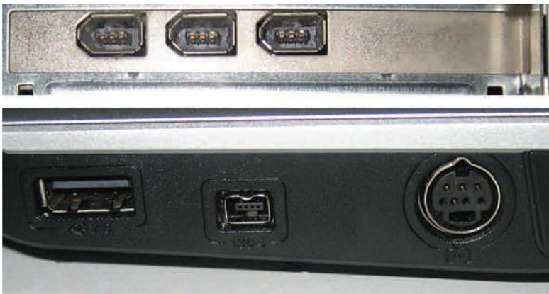
Las cámaras poseen el conector **DV OUT** (Firewire de 4 pines) marcado con el símbolo:
