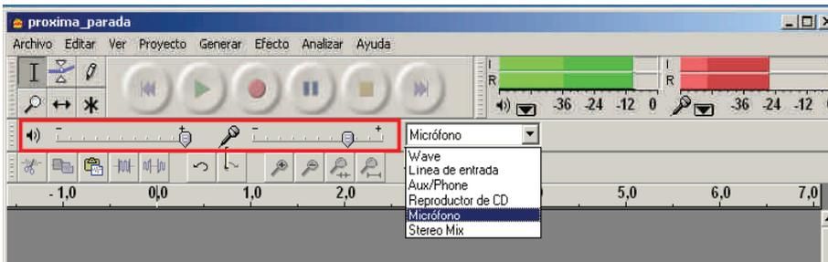
**Controles de volumen.** Los controles deslizantes regulan en volumen de la señal de salida (a la izquierda etiquetado con el altavoz) y el de entrada (a la derecha etiquetado con un micrófono).
